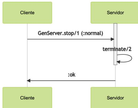
En el diagrama vemos cómo la función `GenServer.stop/1` actúa de forma síncrona. Hasta la detención del proceso no retorna el valor `:ok`. De esta forma podemos estar seguros de la finalización del proceso antes de continuar con otra acción.
